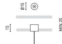
Wire Trimless Accessory est une collection d'accessoires qui permettent d'installer les tendeurs et les câbles des luminaires suspendus d'Arkosligh directement au plafond, sans rosette ni fixation apparente. Ceci permet d'obtenir une application minimaliste et visuellement propre dans l'espace.
